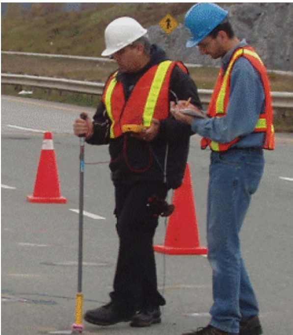
Caractérisation de la corrosion des armatures
